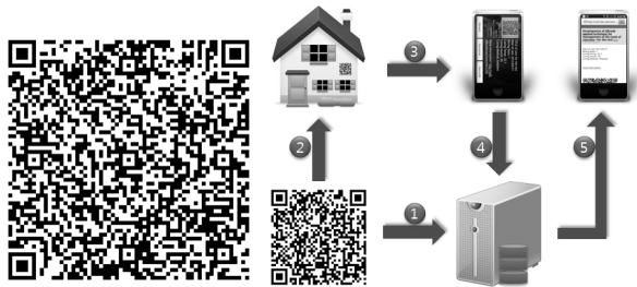
그림 7 제안된 QR코드 및 이를 활용한 제안 기술의 흐름도
