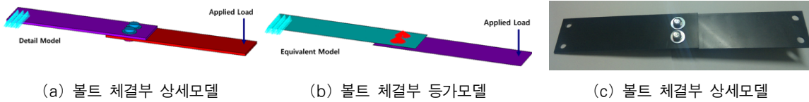
그림 3 볼트체결부 상세모델, 등가모델 및 실제모델
