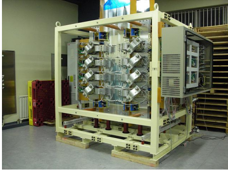
그림 1 8병렬 단상 ac-dc 컨버터 시작품 Fig. 1 The prototype of single phase thyristor ac-dc converter configured with 8 parallel switches
