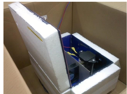
그림 1 실제 제작한 간이 열량계 Fig. 1 Calorimeter for measuring iron loss of filter inductor
