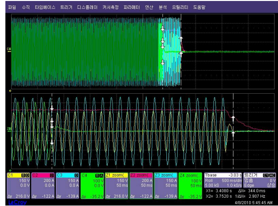
그림 4 단독운전시험(250kW) 결과 파형 Fig. 4 Waveform of results for testing anti-islanding
