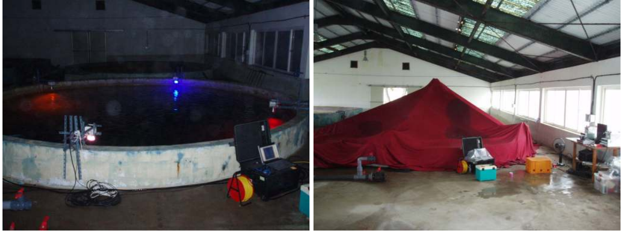
그림 143. 실험수조와 LED집어모듈 설치(좌), 외부 차단막 설치(우).
