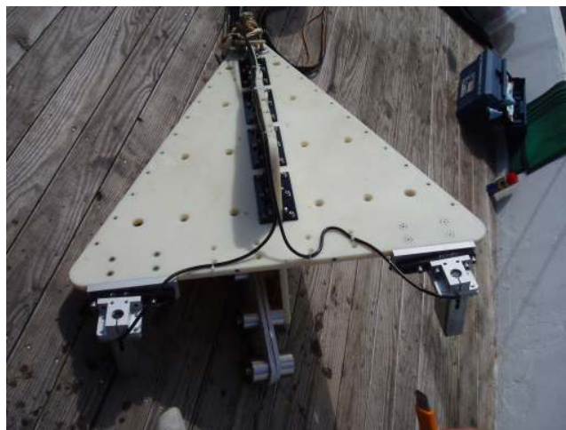
그림 1. 수중카메라가 부착된 예인식 광학시스템.
