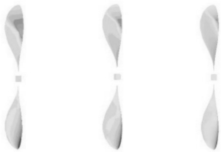
Fig. 6 전진속도 증가에 따른 프로펠러 표면 압력분포(4000 RPM)
