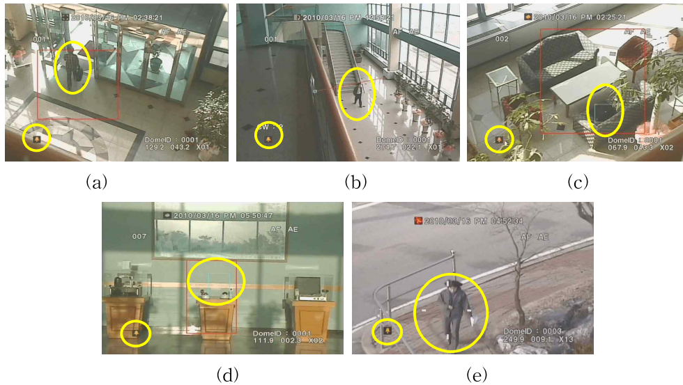
그림 4. 연계가 가능한 지능형 영상 분석 기능 동작 사진 : (a)진입, (b)감지, (c)방치, (d)제거, (e)추적
