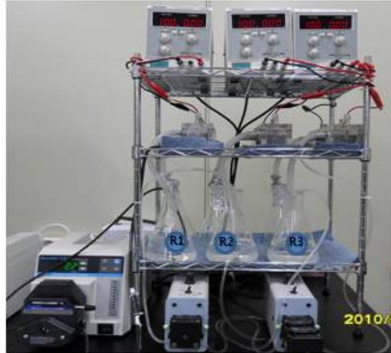
그림 2 EK 반응기 설치 모습
