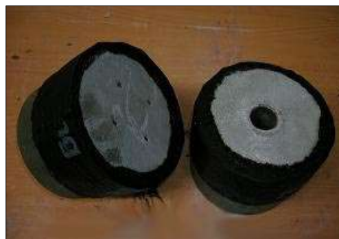
사진 6. 거동 대응성 시험 후 내부 상태
