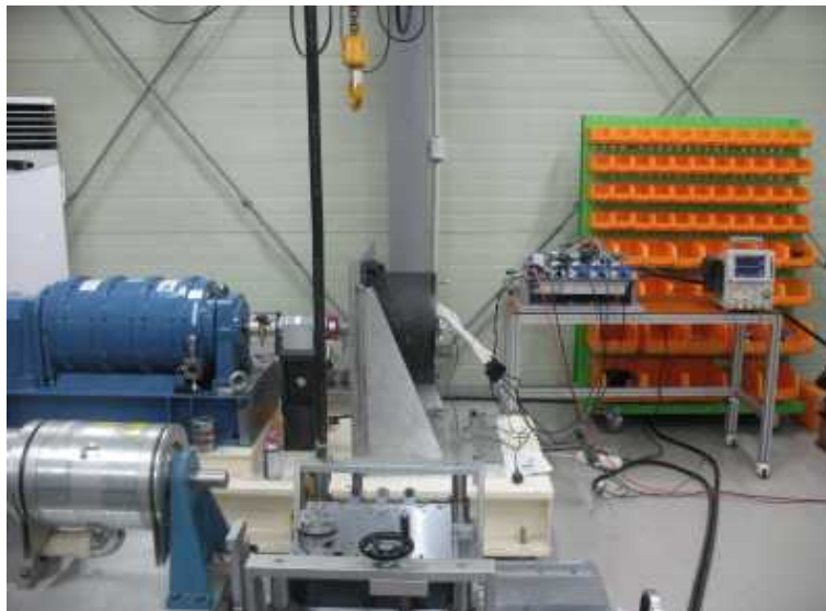
그림 5. PMSM 견인전동기 100kw 부하실험
