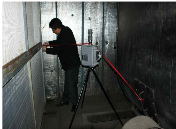
그림 3-1 Mini Volume Air Sampler 설치
