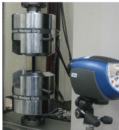
그림 2. 인장시편 및 적외선 카메라 시험 시스템
