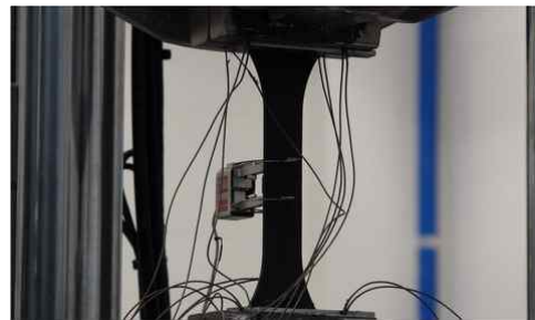
그림 2. Extensometer 설치 전경
