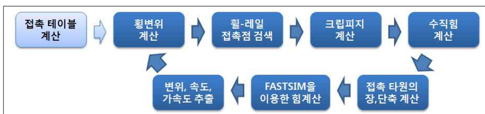
그림1 Wheel-Rail contact procedure
