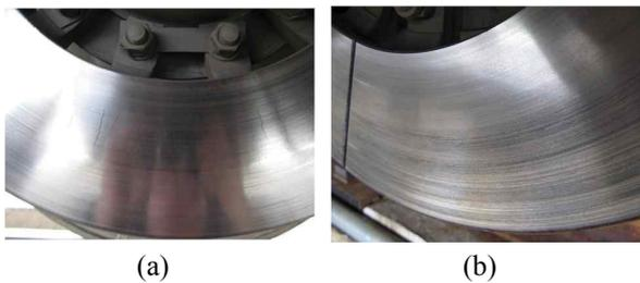
그림16. 리지드/플레서블 브레이크 패드 장착 축-디스크; (a) 리지드, (b) 플레서블
