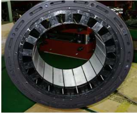
그림5. 견인전동기의 고정자 사진
