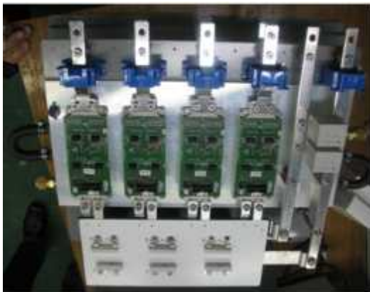
그림3. 추진제어장치 IGBT Stack의 사진
