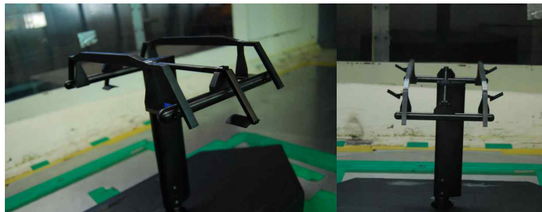
그림 5. 에어포일(좌) 및 스포일러(우)가 장착된 풍동시험모델(1/4 스케일)
