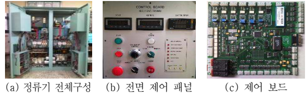
그림 6 제작완료된 대전류 인버터 방식의 정류기 Fig. 6 Manufactured High-Current Rectifier
