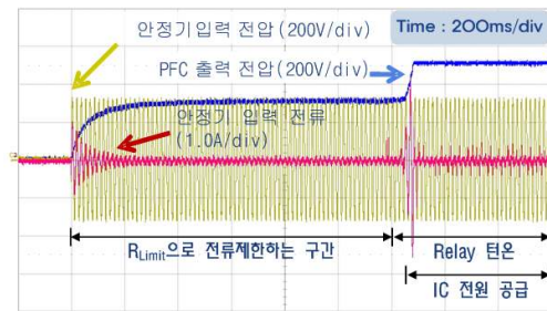
그림 6 돌입전류 제한에 관한 실험 결과 Fig. 6 Experiment result of in-rush current limitation
