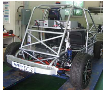
그림 5 차량에 장착한 스택과 인휠모터 Fig 5 Equip a car with Inverter stack and In-Wheel motor
