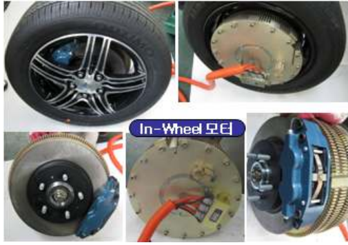
그림 2 In-Wheel Motor의 외관 모습 Fig 2 Outward Appearance of In-Wheel Motor
