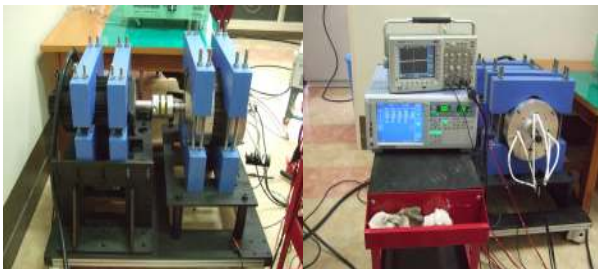
그림 5 모터 특성 실험을 위한 시험 지그 Fig. 5 A Jig for Motor Characteristic test
