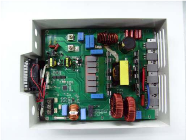
그림 2 연료전지용 전력변환장치 내부 Fig 2. Inside of Fuelcell Power Converter
