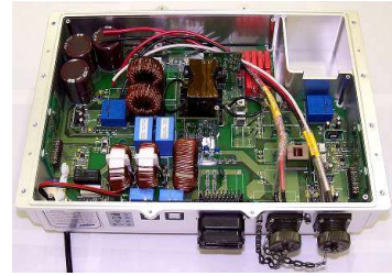
그림 5 개발된 EV용 3.3kW 탭재형 배터리 충전기 하드웨어 Fig. 5 Developed hardware of 3.3kW charger for EVs
