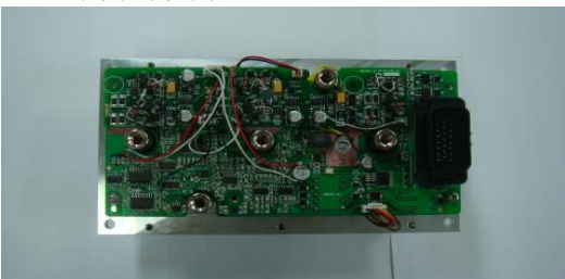
그림 6 제안한 게이트 드라이버 회로를 적용한 인버터
