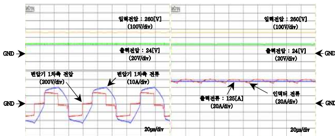
그림 3 변압기 1차측 전압과 전류, 인덕터 전류, 입·출력 전압과 출력 전류 실험 파형 Fig. 3 Experimental waveform of transformer primary voltage and current, inductor current, input and output voltage and output current.
