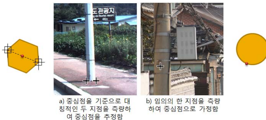
[그림 2] 영상 기반 차량 MMS를 이용한 시설물 중심점 측량의 예
