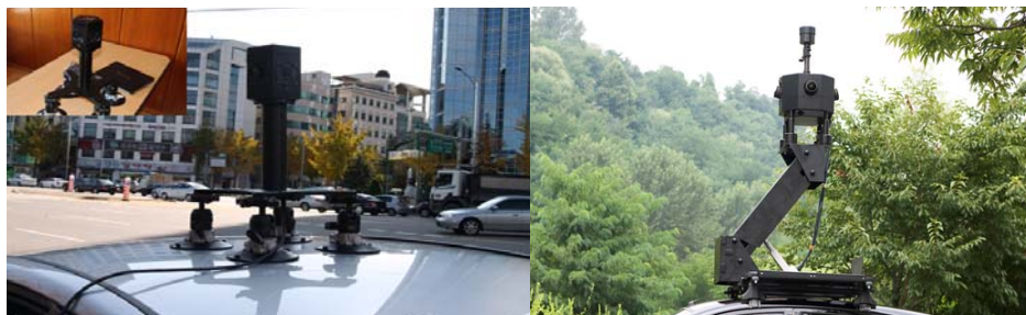
(a) 200만 화소 카메라로 구성된 장비 (b) 1000만 화소 카메라로 구성된 장비
