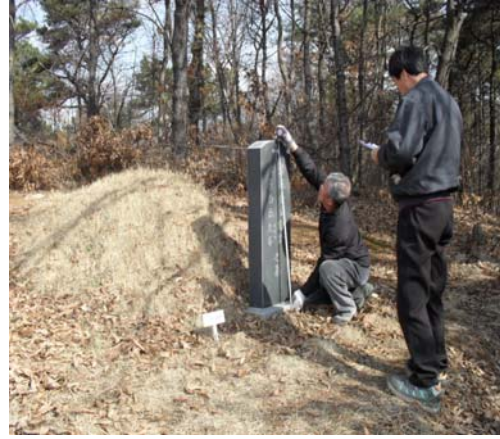
[그림 1] VRS-RTK 에 의한 분묘위치 측정
