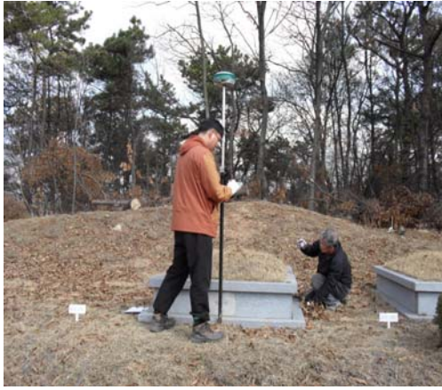
[그림 1] VRS-RTK 에 의한 분묘위치 측정
