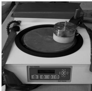
그림 3. 콘크리트 표면 연마기
