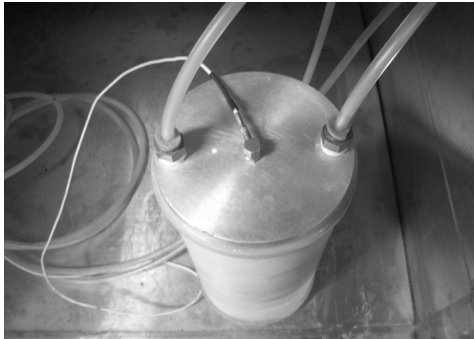
사진 1. 가속도계가 설치된 단부캡
