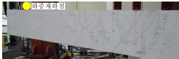
그림2. 균열 및 파괴(PC)
