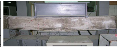
그림 3 B_FRP 휨 시험 및 균열 패턴
