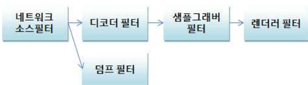
그림 2 실시간 영상 재생 관련 필터 구성도
