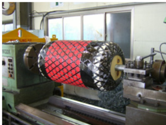
Fig. 6 실리콘 고무 금형을 금속 mandrel에 장착한 후 탄소 섬유를 필라멘트 와인딩 하는 장면
