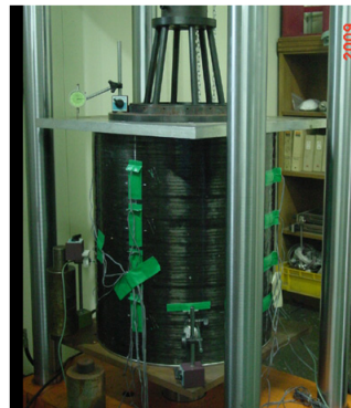
Fig. 14 압축 하중 50,000 Kgf을 가하면서 변형율 측정
