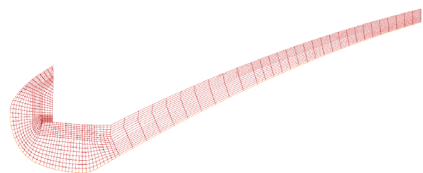
Fig. 8 노즐 조립체의 유한요소 모델
