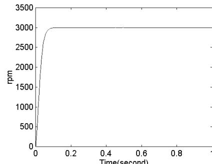
[그림 6]  $J \times 30$ 의 응답곡선
