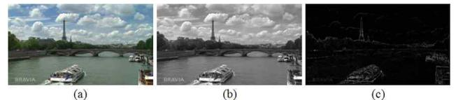
그림 2. Y 버퍼와 Depth filter 영상. (a) 입력 영상, (b) Y 버퍼 영상 (c) 깊이 영상
