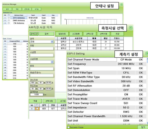
<그림 2> 측정 안테나, 측정 채널, 계측기 설정 과정
