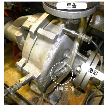
그림 3. 가속도계 설치 형상
