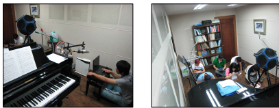
그림 4. 청감실험 장비 및 실험장면
