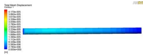
Figure 4 정상 유연관 벽의 Displacement
