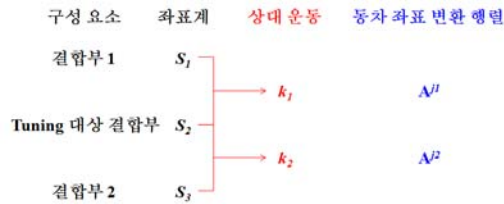
Fig. 2 Coordinate system of Machine tool joint 는 좌표계를 Fig. 2와 같이 설정한다.
