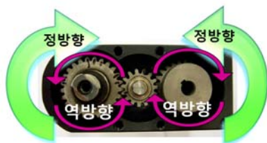
Fig. 3 단방향 클러치 베어링이용 구동 원리
