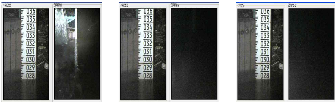
그림 2. 야간 조명 제어의 오작동으로 인해 결측이 발생한 사례(전류리 지점)
