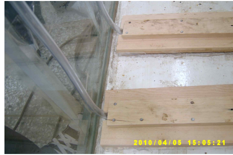
그림 6. 액주계 보호구 설치
