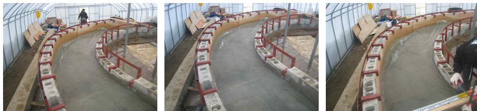
그림 5. 만곡부 흐름 (좌로부터 500 m^3/s , 600 m^3/s , 700 m^3/s )
