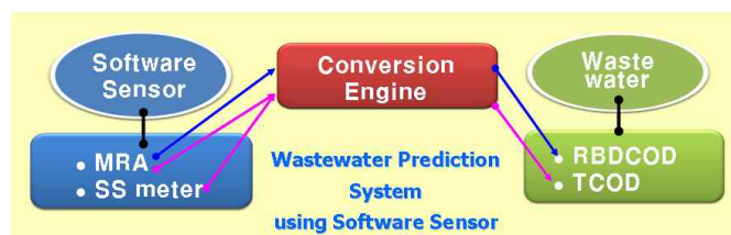
Fig. 2 실시간 하수처리장 유입수 분석 알고리즘 개요도
