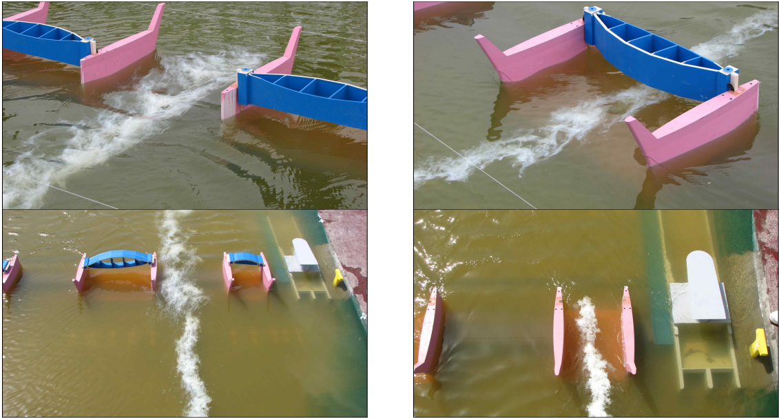
그림 5. 계획홍수시 고정보 및 가동보 통과 흐름 유황
